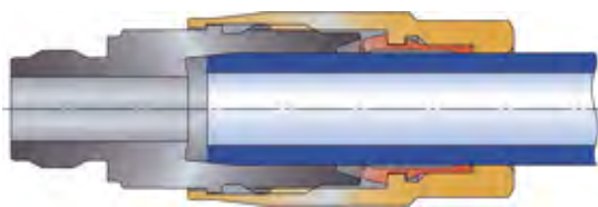
Anschluss, offener Zustand
